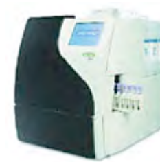
Máy phân tích HbA 1c BioRad D10 – một ví dụ về máy phân tích bench top (với bánh xe đẩy) dùng để đo HbA 1c
